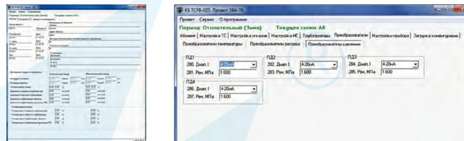
Приложение «Конфигуратор базы» предназначено для автоматизации процесса создания проектной документации УУТЭ и конфигурирования тепловычислителей в соответствии с проектом. Поддерживаемые тепловычислители: ТСРВ-024 (-024М), ТСРВ-026 (-026М), ТСРВ-025, ТСРВ-042.
