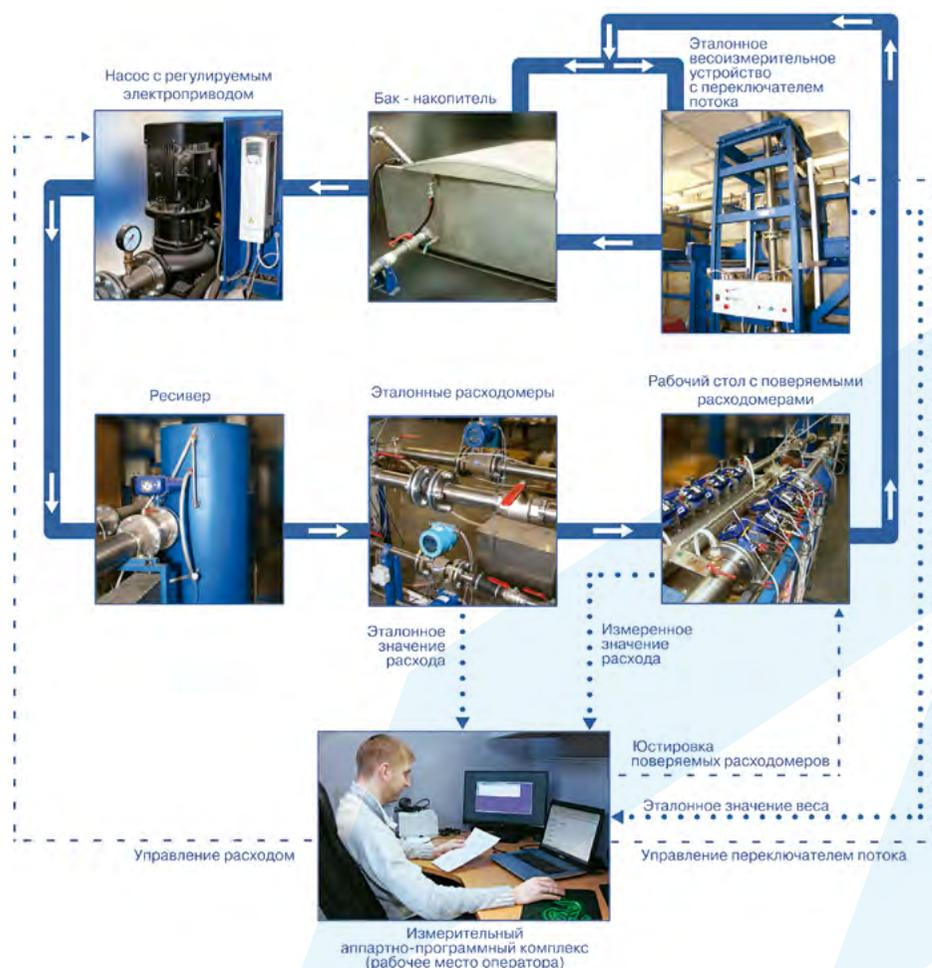
Структурная схема установки
