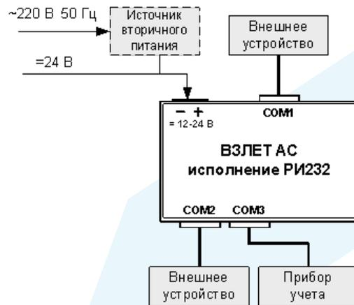
Принципиальная схема подключения адаптера - разделителя интерфейсов РИ232
