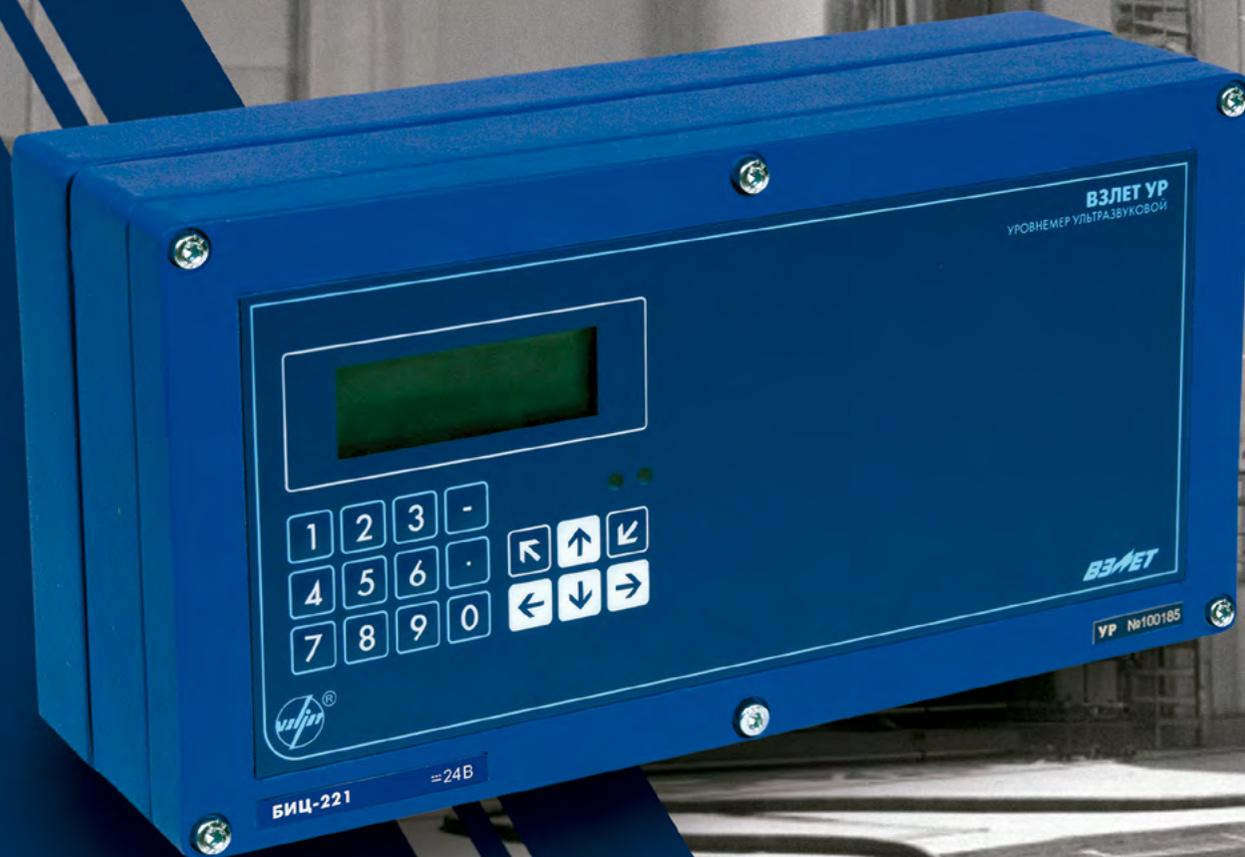
Предназначены для бесконтактного измерения уровня различных жидкостей и дистанции до границы раздела сред, в том числе во взрывоопасных зонах. Может использоваться в качестве сигнализатора или дальномера. Позволяет определять средний уровень и перепад уровней в двух точках, наполнение и объем жидкости в резервуарах с известными объемными характеристиками.
