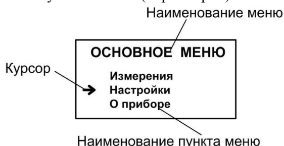
Рис.6 - Вид основного меню расходомера.
