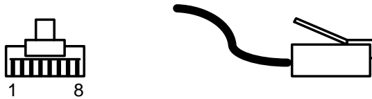
а) вид и нумерация контактов разъема RJ45
