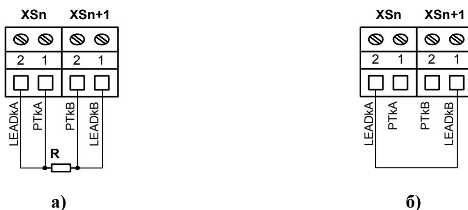
**Рис. Е.1. Схема подключения при проверке каналов измерения температуры.**
