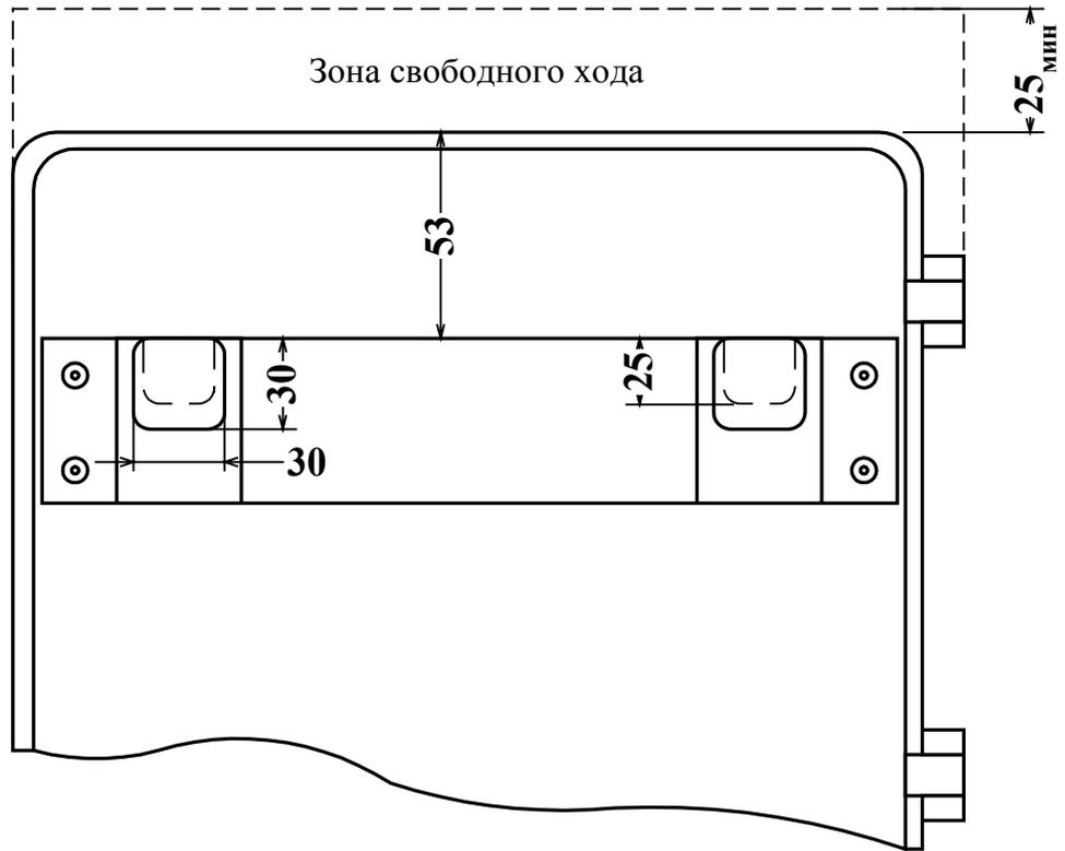
а) вид сзади ТВ с монтажной планкой
