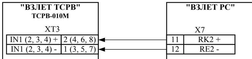
**б) расходомера ультразвукового «ВЗЛЕТ РС»**
