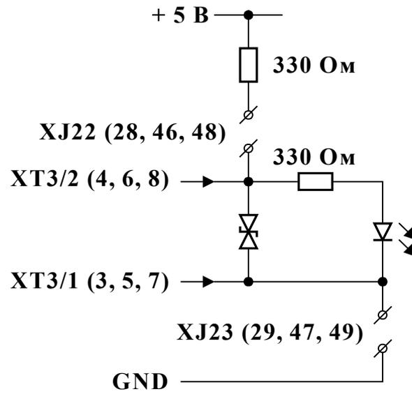
**Рис. Г.7. Схема входного каскада импульсного входа расхода.**
