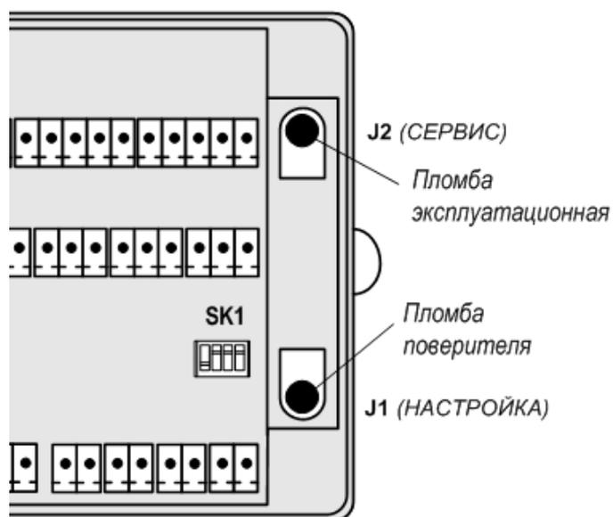
**Рис.А.4. Места пломбирования ТВ на плате модуля вычислителя.**
