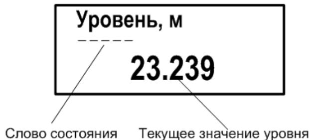
**Рис.2. Вид окна укрупненной индикации измеряемого параметра.**
