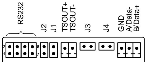
ПРИМЕЧАНИЕ. К 8-контактному разъему RS-232 подключается кабель от внешнего разъема RS-232, расположенного на наружной поверхности монтажного модуля (см. рис.А.1).
