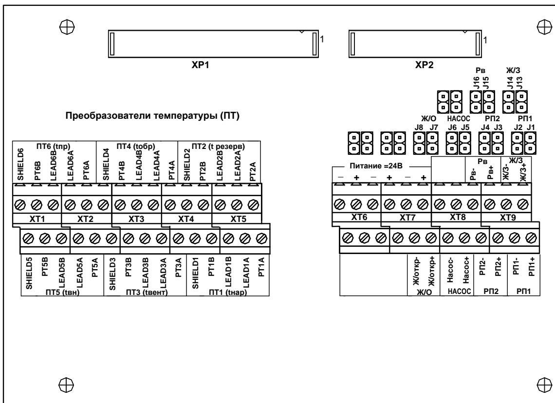
XT1-XT5 - контактные колодки подключения кабелей связи с ПТ1...ПТ6;
