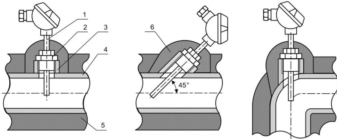
1 – термопреобразователь сопротивления; 2 – защитная гильза;
