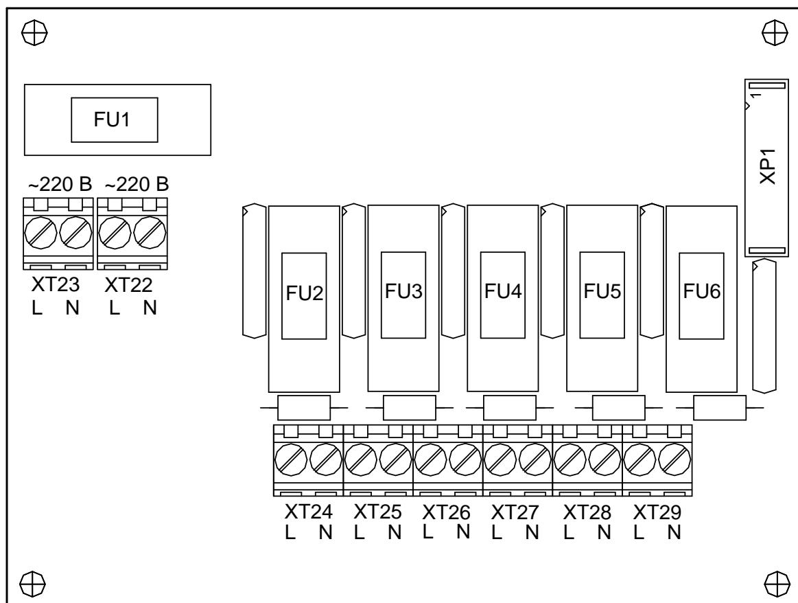
XT22, XT23 - контактные колодки подключения кабелей ~220 В 50 Гц;
