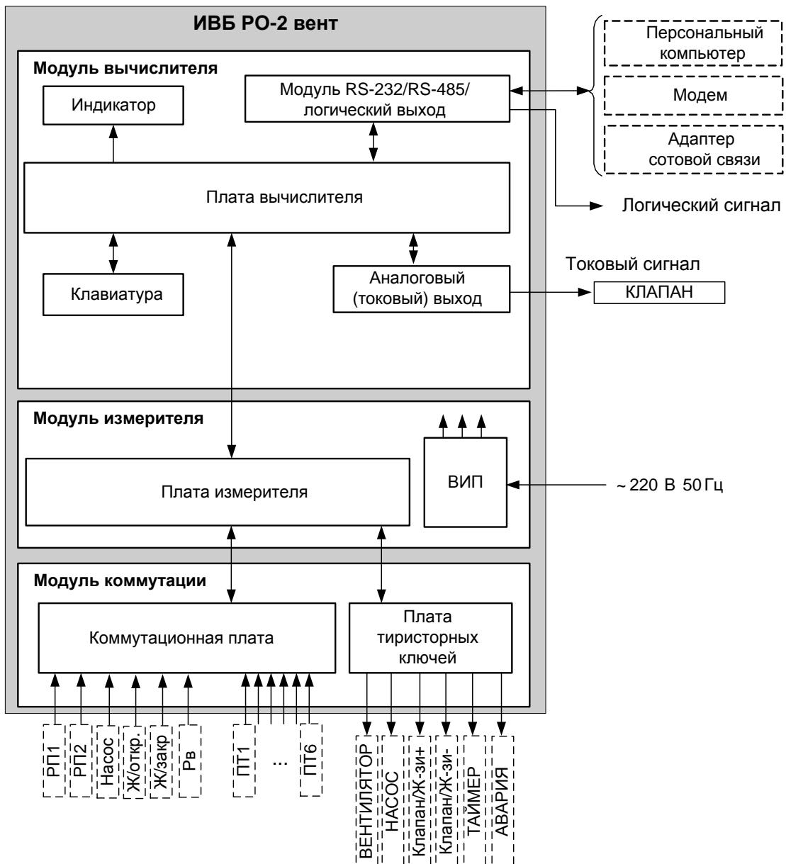
ВИП – вторичный источник электропитания; ПТ, РП, Насос, Ж/откр (Ж/закр), Рв – входы преобразователей температуры, реле потока, выключателей жалюзи, насоса, электроконтактного манометра.
