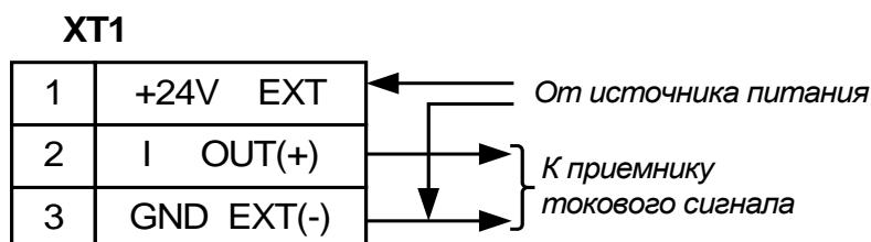
**Рис. Б.3. Разъем XT1 токового выхода расходомера на плате модуля токового выхода.**
