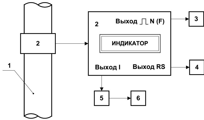
1 – трубопровод поверочной установки; 2 – расходомер; 3 – счетчик импульсов (частотометр); 4 – персональный компьютер; 5 – магазин сопротивлений; 6 – вольтметр.
