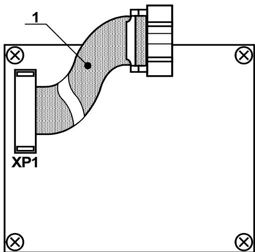
1 – шлейф связи с модулем обработки;
