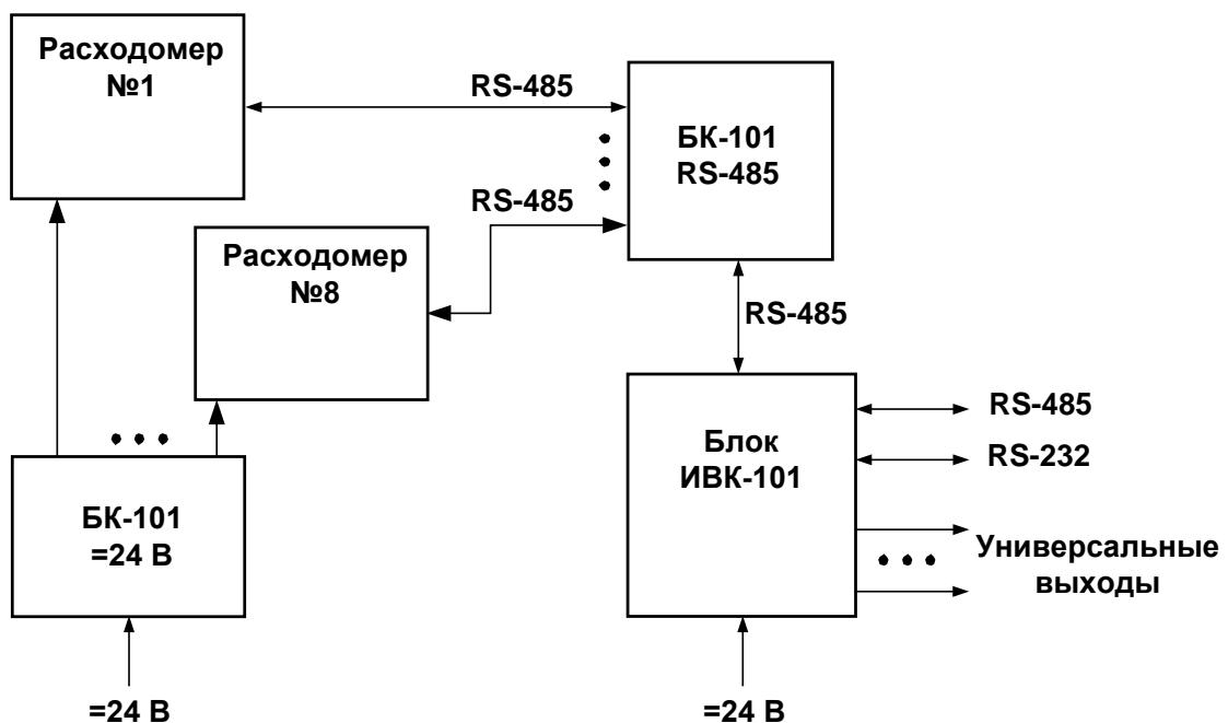
**Рис.8. Система сбора данных и выносной индикации на базе комплекса «ВЗЛЕТ ИВК» исполнения ИВК-101 с использованием БК-101 для 2-8 расходометров.**
