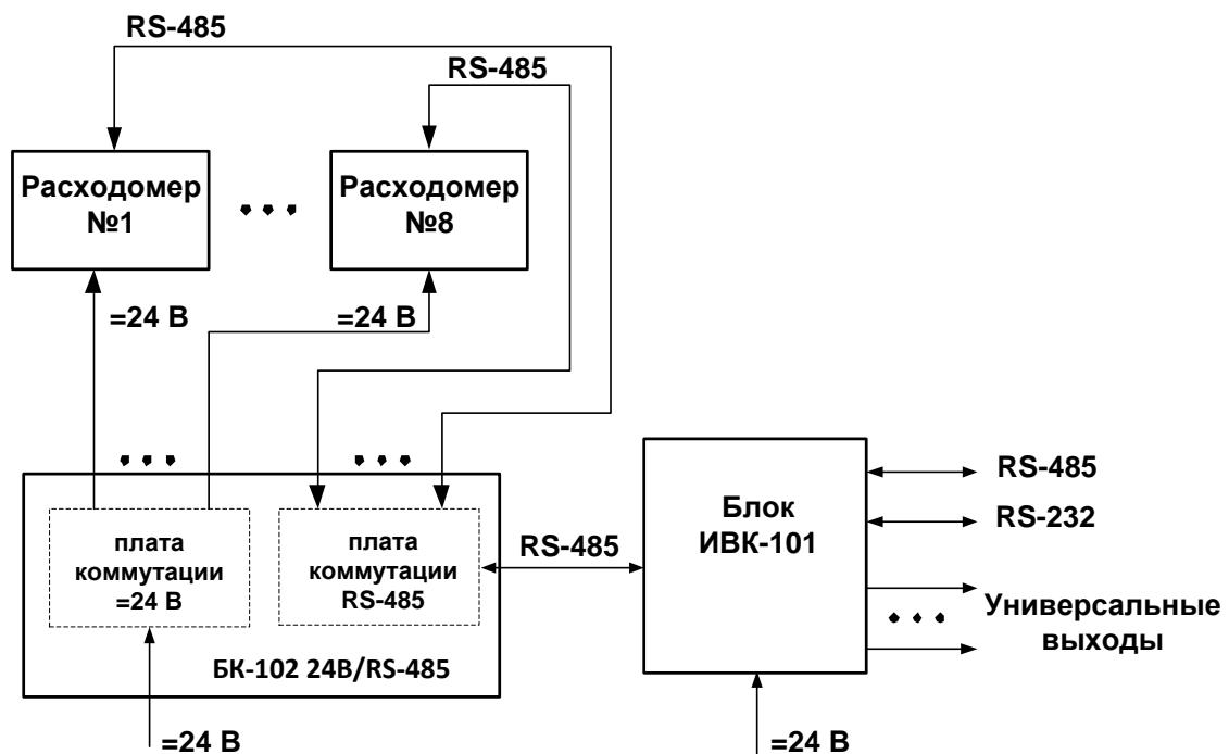
**Рис.7. Система сбора данных и выносной индикации на базе комплекса «ВЗЛЕТ ИВК» исполнения ИВК-101 с использованием БК-102 для 2-8 расходометров.**
