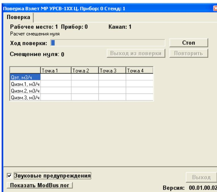
**Рис. 45. Окно программы, отражающее измерение смещения нуля**
