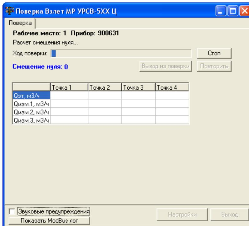
Рис. 34. Окно программы, отражающее измерение смещения нуля.
