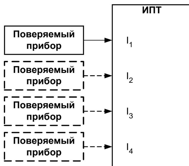
Рис. 13. Схема сопряжения поверяемых приборов с ИПТ.
