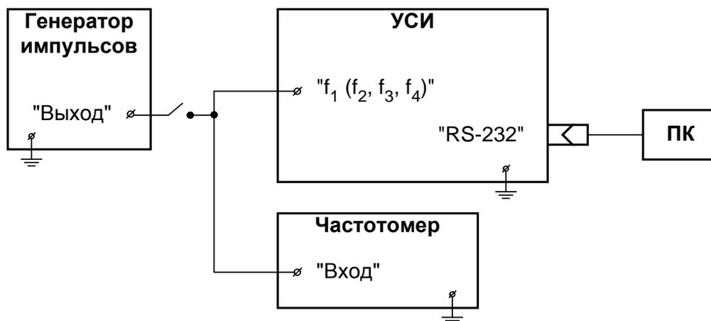
Рис. 54. Схема подключения модуля счетчика импульсов при поверке.
