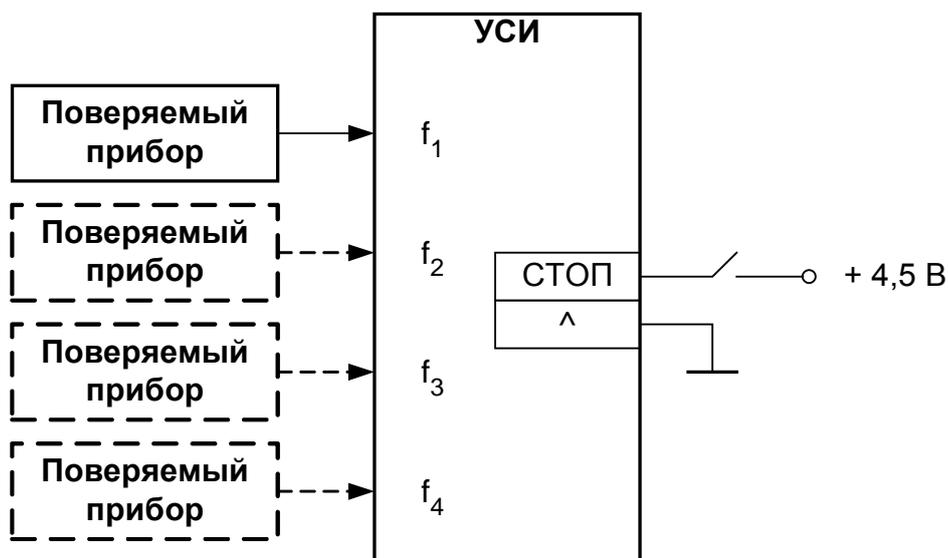
Рис. 12. Схема сопряжения поверяемых приборов с УСИ.
