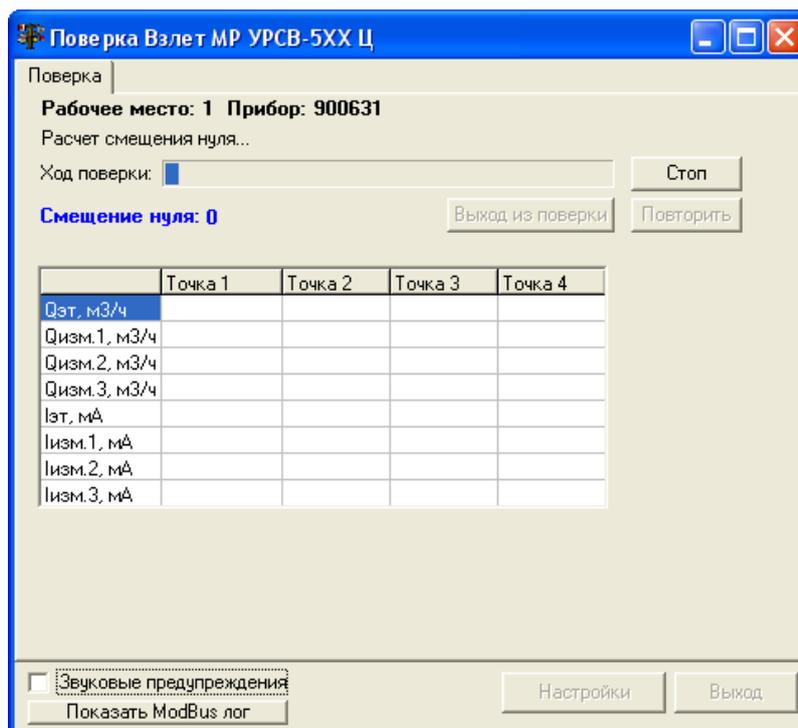
Рис. 30. Окно программы, отражающее измерение смещения нуля.
