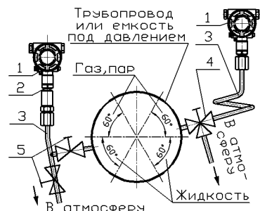
Рисунок 14 - Рекомендации по монтажу датчиков (кроме моделей 54X4, 5XX5 и 55X6).
