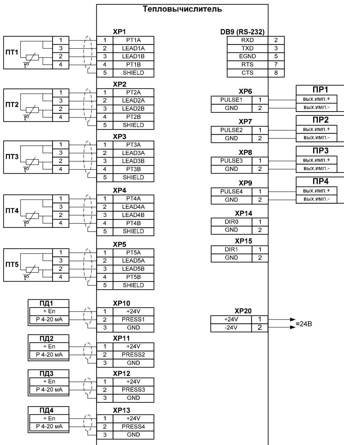
Рис.Ж.1. Схема подключения тепловычислителя «ВЗЛЕТ ТСРВ» исполнений ТСРВ-026, -026М.
