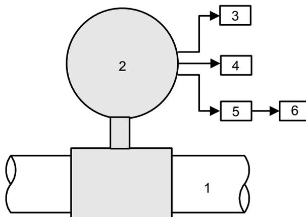
*1 – трубопровод поверочной установки; 2 – расходомер; 3 – счетчик импульсов (частотомер); 4 – персональный компьютер; 5 – магазин сопротивлений; 6 – вольтметр.*
