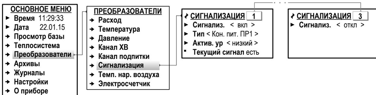
Рис.27. Вид меню настройки входов «Сигнализация» (режим СЕРВИС).
