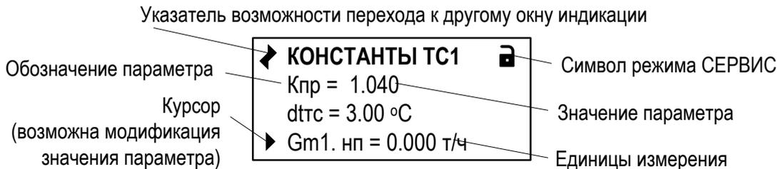
**Рис.8. Вид одного из окон индикации многооконного меню.**
