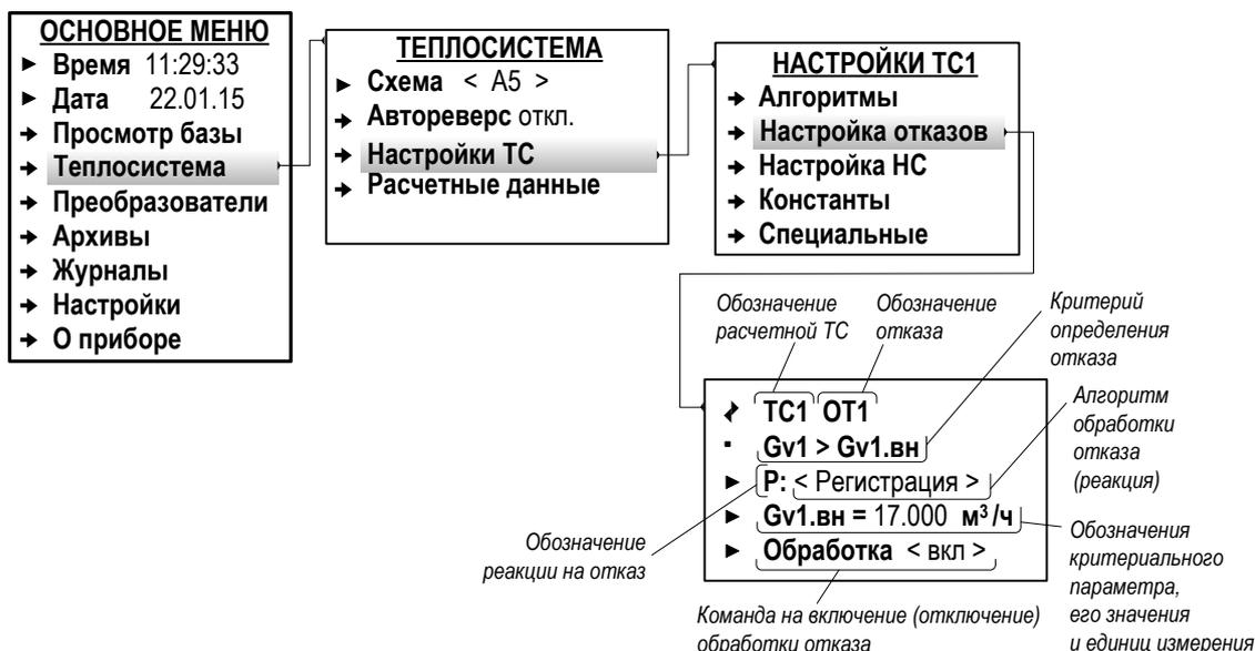
Рис.36. Вид меню настройки обработки отказов (режим СЕРВИС).
