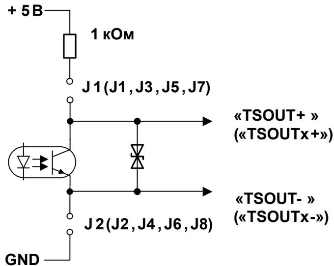
**Рис. Б.6. Схема оконечного каскада универсальных выходов.**
