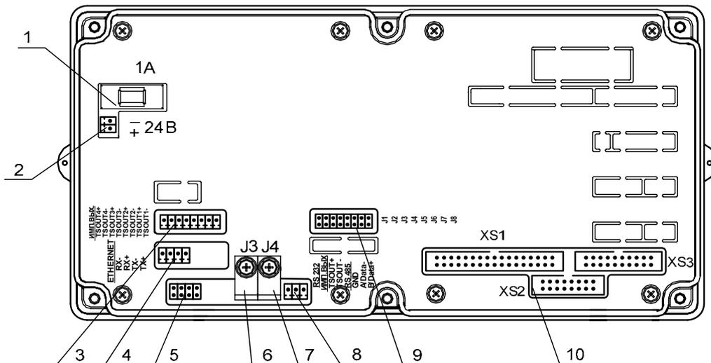
1 – предохранитель; 2 – разъем подключения кабеля питания +24 В; 3 – разъем универсальных выходов 1-4 сервисного модуля; 4 – разъем модуля Ethernet; 5 – разъем подключения кабеля связи RS-232; 6, 7 – контактные пары для установки режима управления ТВ J3 и J4 соответственно; 8 – разъем подключения кабеля связи RS-485; 9 – контактные пары для установки режимов работы универсальных выходов 1-4 сервисного модуля; 10 – разъемы для подключения шлейфов связи с блоком коммутации.
