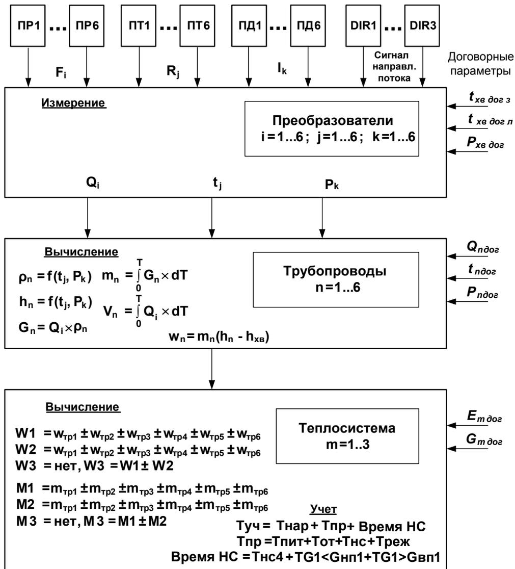
*ПР, ПТ, ПД – преобразователи расхода, температуры, давления; ТР – расчетный трубопровод;  $F_i$  – частота следования импульсов ПРi;  $R_j$  – сопротивление ПТj;  $I_k$  – выходной ток ПДk.*
