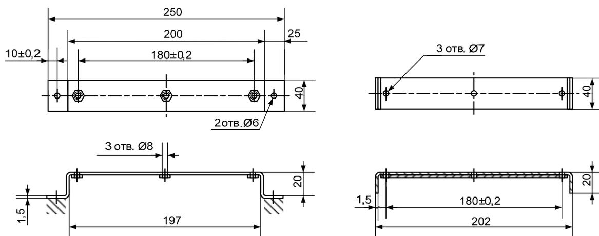
Рис. А.6. Скобы монтажные для крепления кабелей связи.
