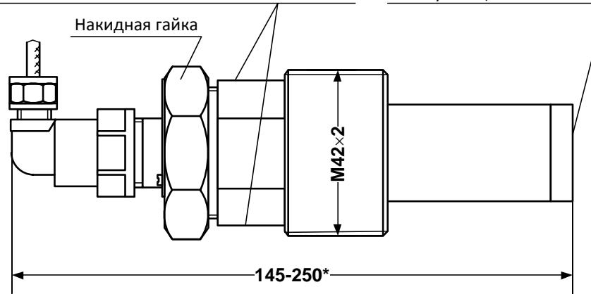
в) с титановым протектором и накидной гайкой
