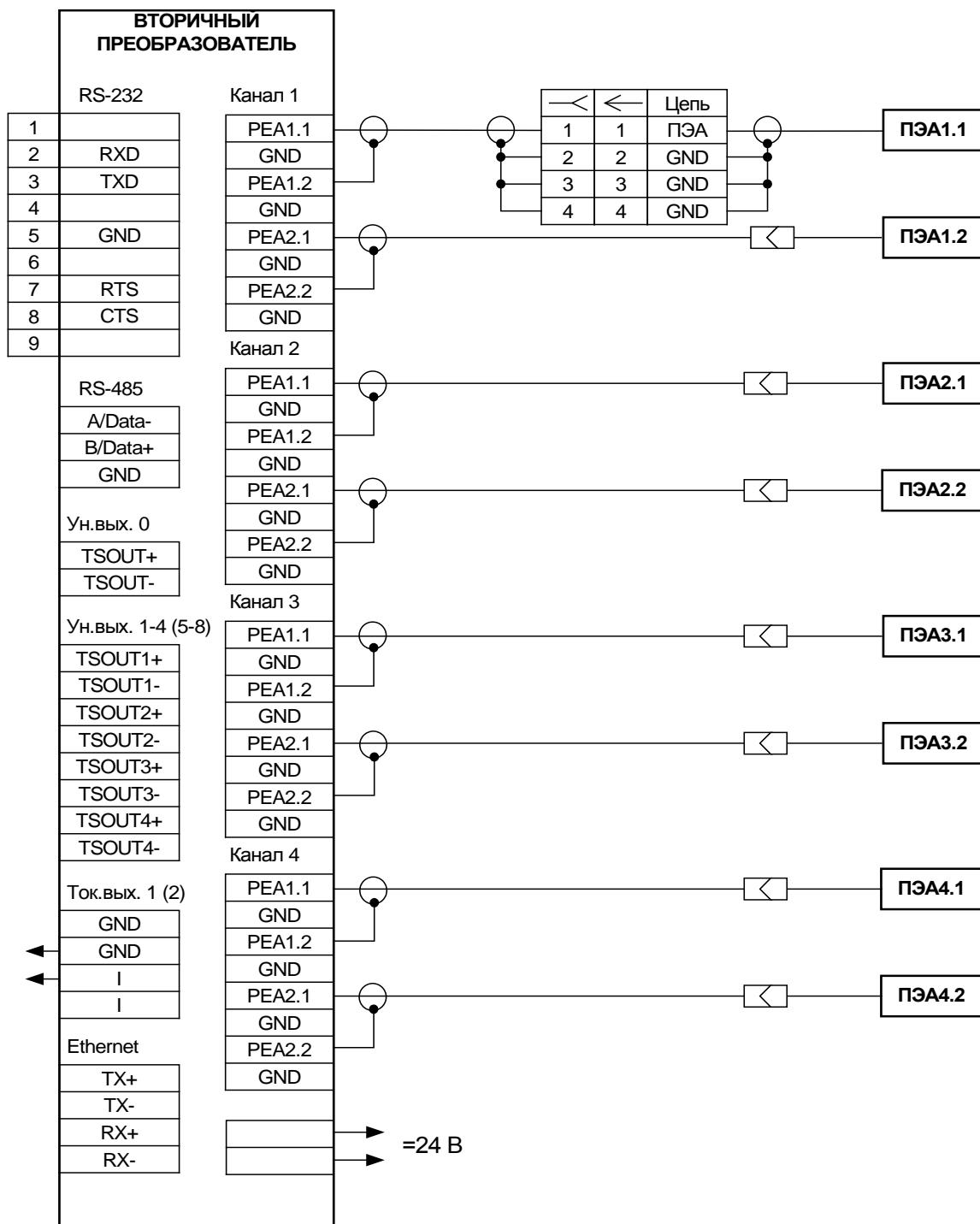
Рис.Б.1. Схема соединений расходомеров исполнения УРСВ-54x ц.
