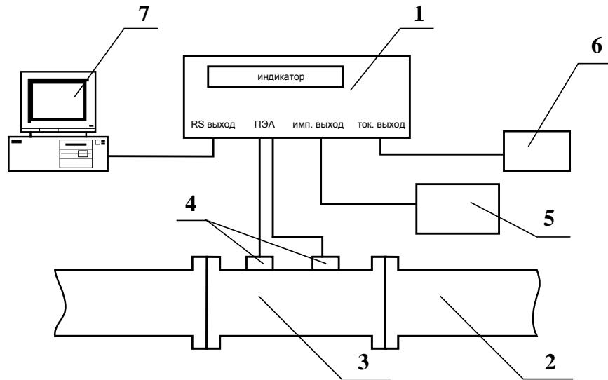
1 – вторичный преобразователь поверяемого расходомера; 2 – трубопровод поверочной установки; 3 – измерительный участок; 4 – преобразователи электроакустические; 5 – частотометр; 6 – миллиамперметр; 7 – персональный компьютер.
