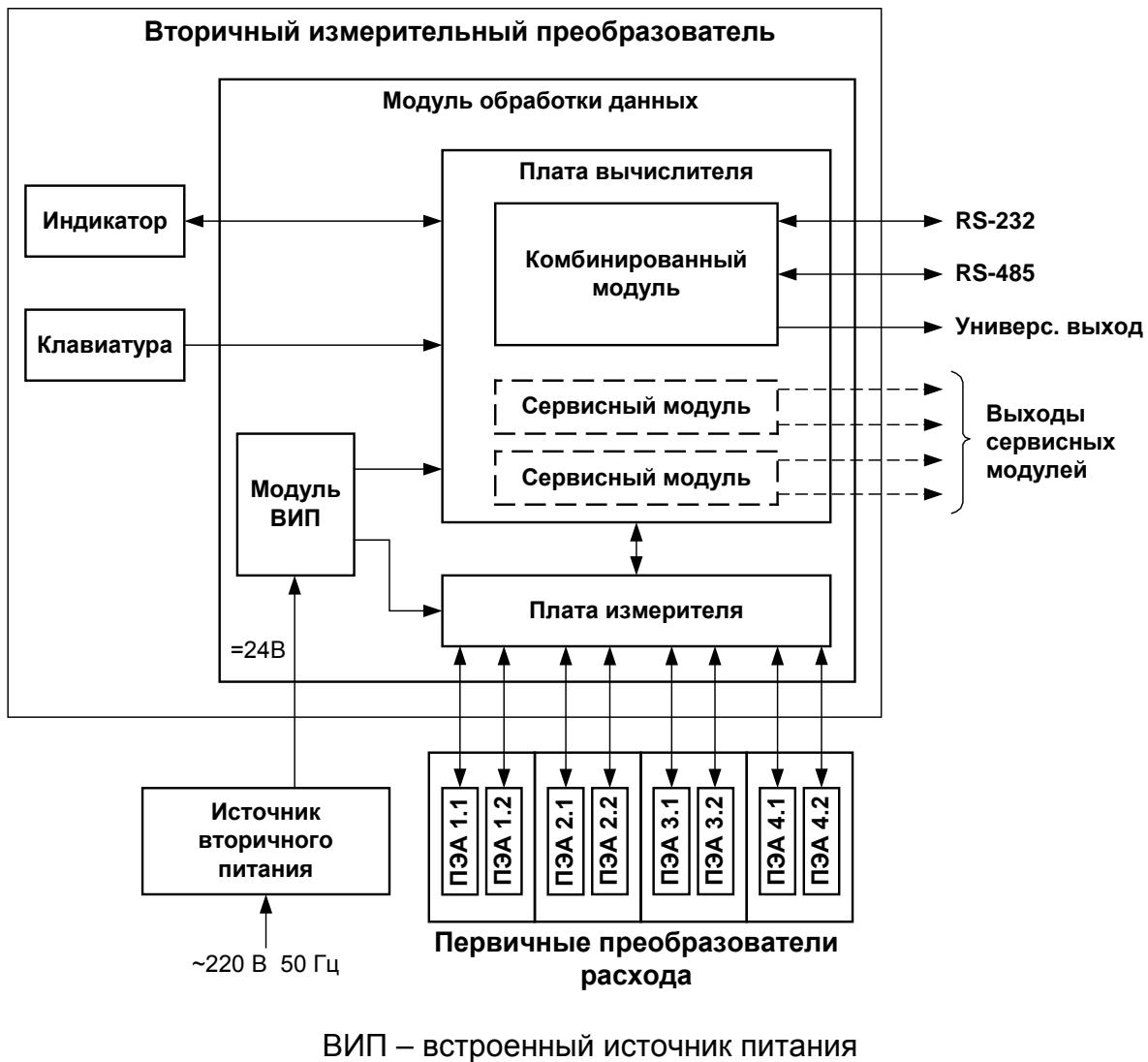
Рис. 4. Структурная схема четырехканального расходомера.
