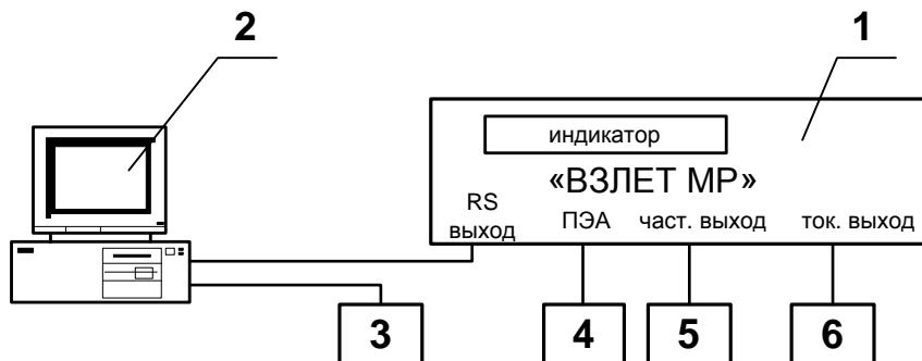
1 – вторичный преобразователь поверяемого расходомера; 2 – персональный компьютер; 3 – комплекс поверочный «ВЗЛЕТ КПИ»; 4 – акустический стенд с установленными ПЭА; 5 – частотометр; 6 – миллиамперметр.
