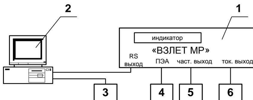
1 – вторичный преобразователь поверяемого расходомера; 2 – персональный компьютер; 3 – комплекс поверочный «ВЗЛЕТ КПИ»; 4 – акустический стенд с установленными ПЭА; 5 – частотомер; 6 – миллиамперметр.
