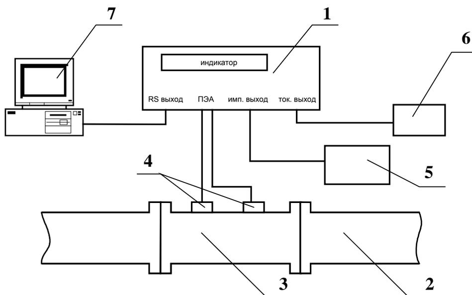
1 – вторичный преобразователь поверяемого расходомера; 2 – трубопровод поверочной установки; 3 – измерительный участок; 4 – преобразователи электроакустические; 5 – частотомер; 6 – миллиамперметр; 7 – персональный компьютер.
