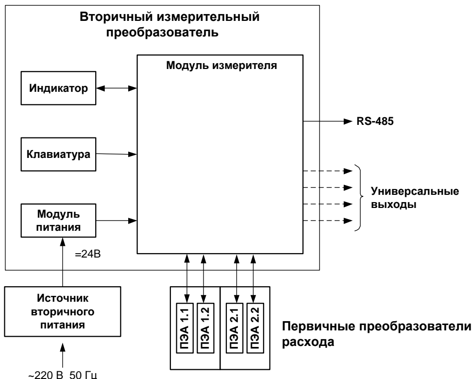
Рис. 4. Структурная схема двухканального расходомера.
