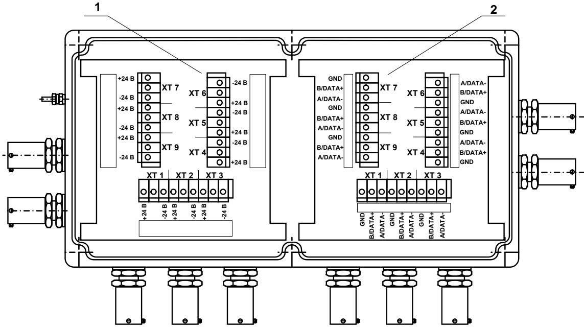
1 – плата коммутации =24 В; 2 – плата коммутации RS-485;
