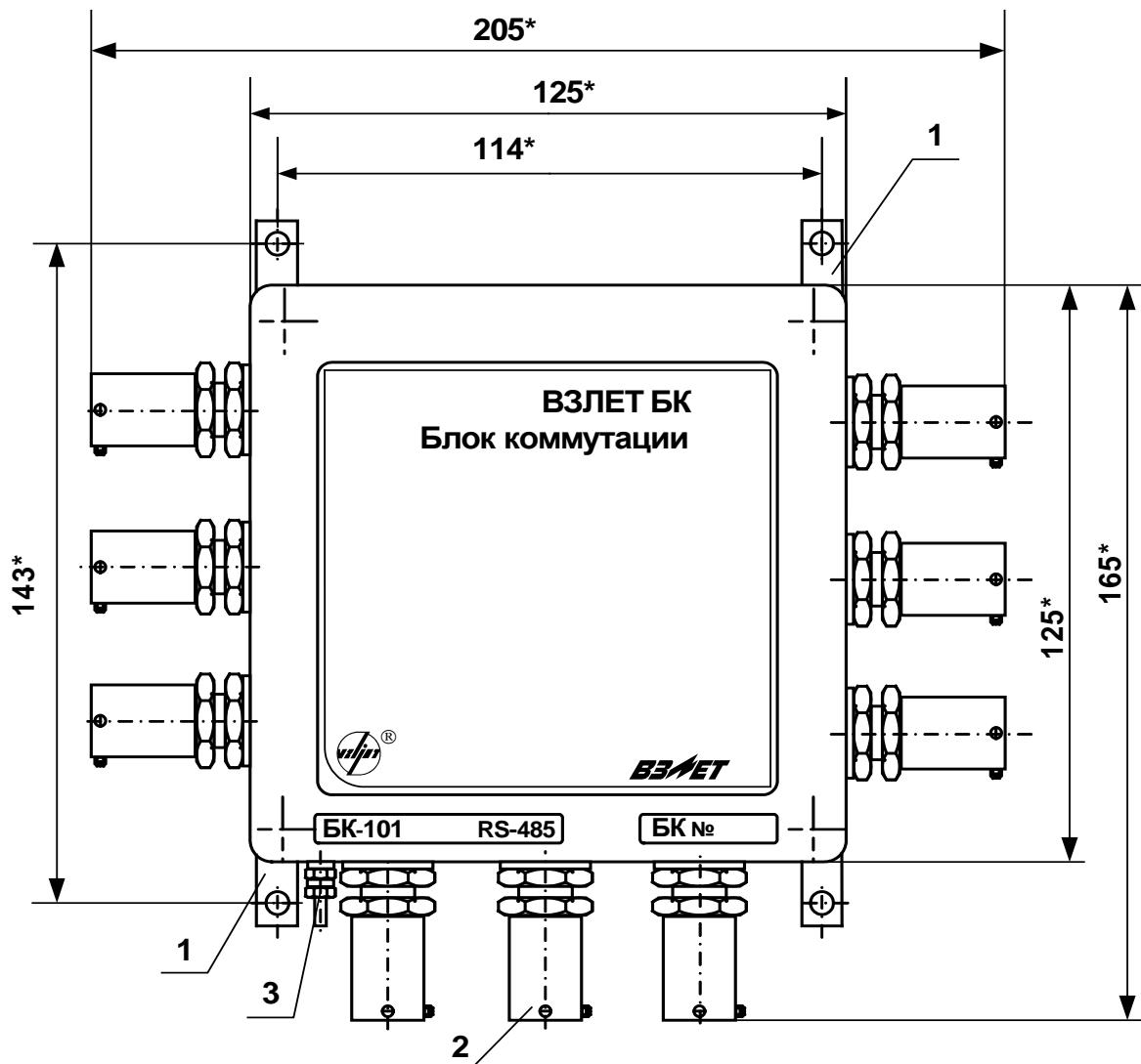
1 – монтажная планка; 2 – гермоввод для кабеля с внешним диаметром до 8,5 мм (остальные – для кабелей с внешним диаметром до 6 мм); 3 – винт крепления заземляющего проводника.
