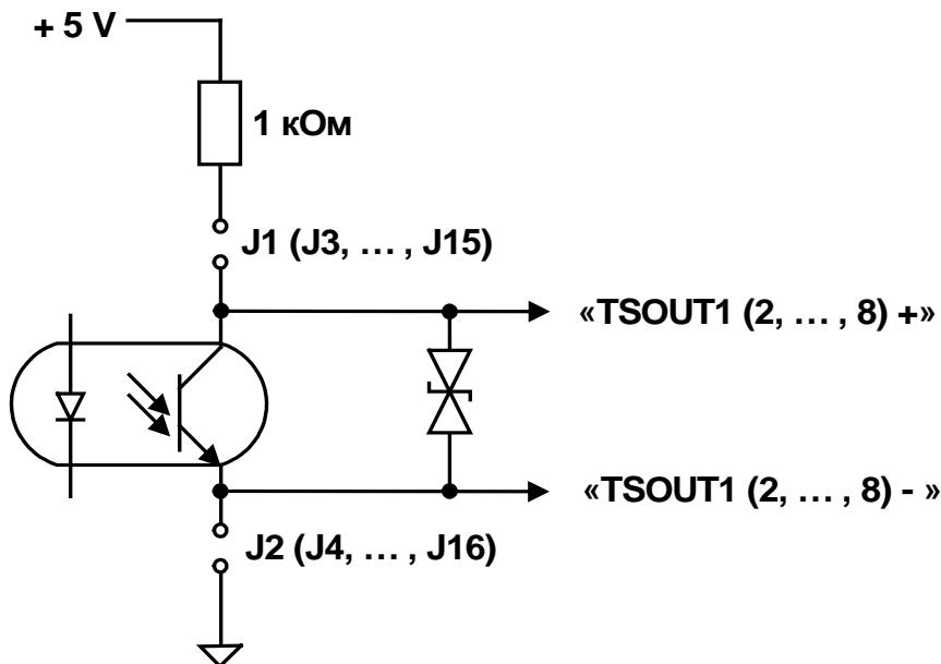
Рис. Б.1. Схема оконечного каскада универсальных выходов.
