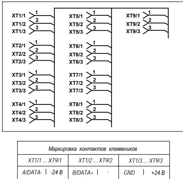
**Рис.А.9. Принципиальная схема плат блоков коммутации БК-101 и БК-102.**
