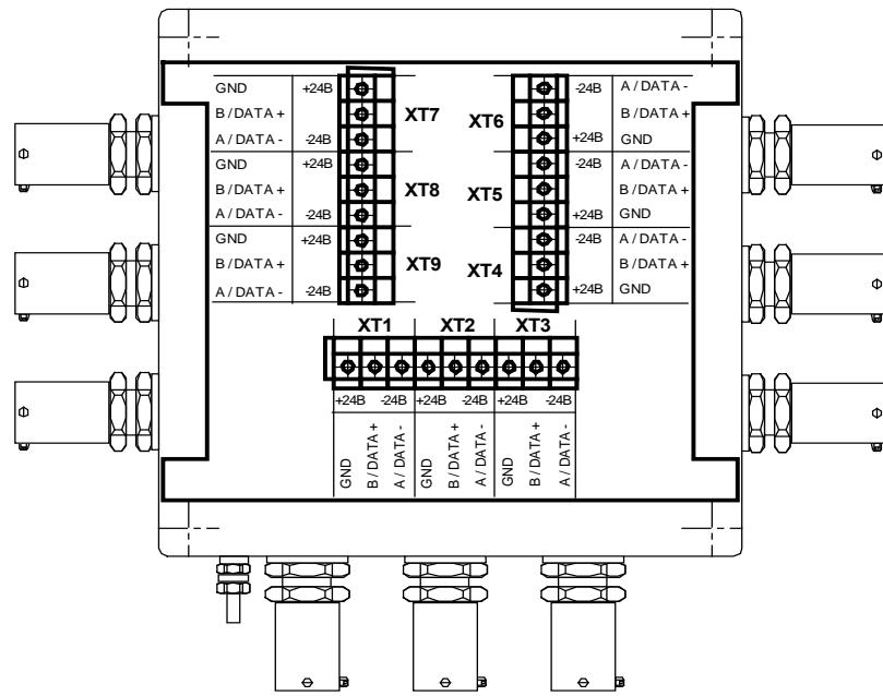
**ХТ1-ХТ9** – контактные колодки подключения кабелей связи по интерфейсу RS-485 (БК-101 RS-485 и БК-101Ex RS-485) либо кабелей питания =24В (БК-101 =24В и БК-101 Ex =24В).
