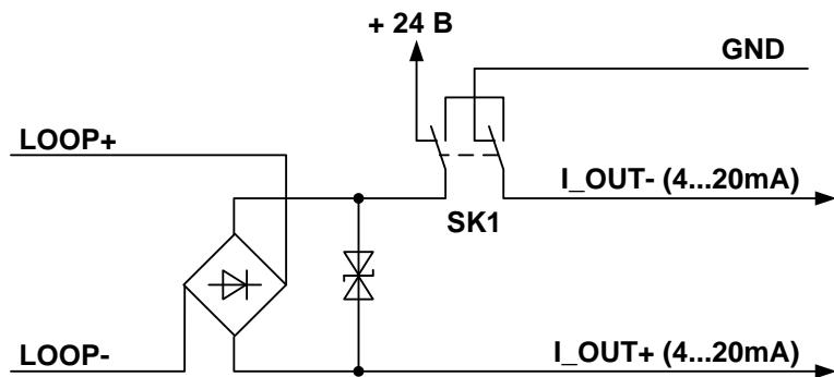
**Рис. Б.2. Схема токового выхода расходомера**
