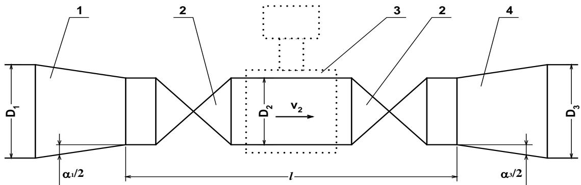
1 – конфузор; 2 – полнопроходная шаровая задвижка; 3 – ППР;
