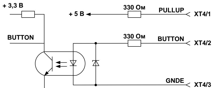
**Рис. Б.3. Схема входного каскада БИ.**
