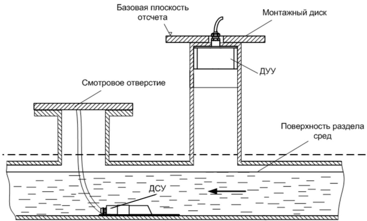
Рис.Б.4. Общий вид смонтированных датчиков.
