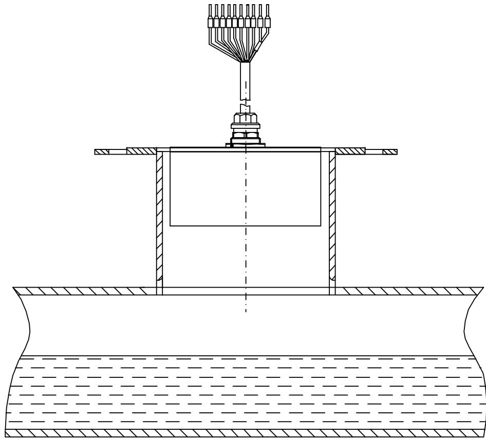
**Рис.Б.2. Монтаж ДУУ с помощью установочного патрубка.**
