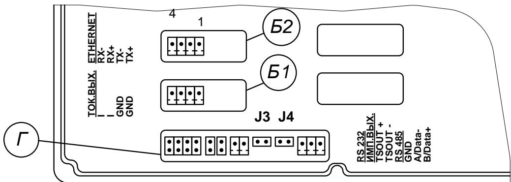
**Рис.Д.6. Маркировка коммутационных элементов модулей токового выхода и интерфейса Ethernet.**
