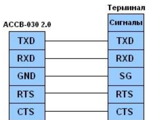
Рис.15. Схема подключения ACCB-030 2.0 к терминалу аппаратного управления потоком.
